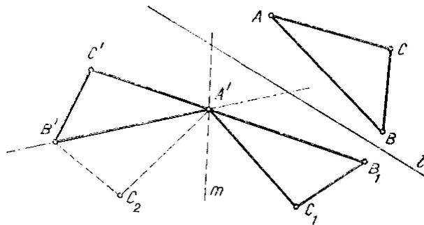
図 2.20: 平面運動の対称変換への分解
