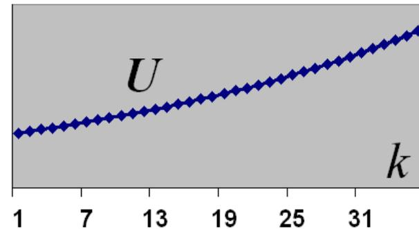
**Экспоненциально-модулированная гармоника:**  $f_n = Ae^{\alpha n} \cos(2\pi\omega n)$ .
